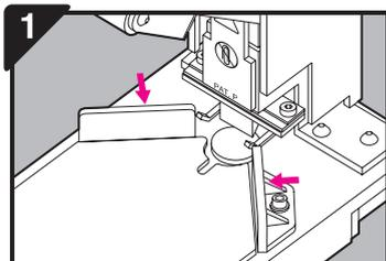
將兩側板向內推到緊靠工作台面兩邊，再用圓頭六角板手將固定螺絲鎖緊。
