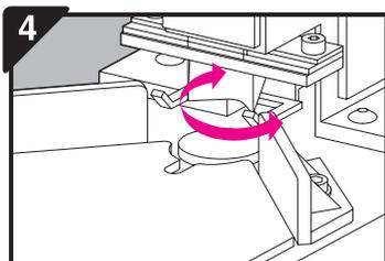
機台應隨時裝有塑膠墊，以保護刀具之刀口，為增加塑膠墊使用次數，所以當塑膠墊被刀具切割到無法再切斷紙張時，請用一字型六角板手輕輕的旋轉塑膠墊（如圖示方向），換個新位置就可再使用。
