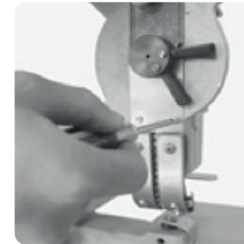
3. Die beiden M3 - Schrauben, mit denen der Ösenkanal an der Maschine befestigt ist, lösen und Ösenkanal vorsichtig absenken.
