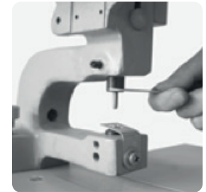
5. Schrauben Sie den Oberstempel mit dem Gabelschlüssel aus dem Zylinder.
