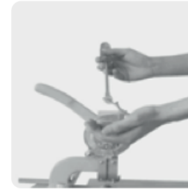
1. Ösen aus dem Magazin entfernen.
