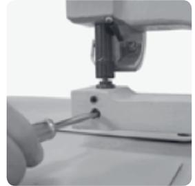
15. Zum Schluss noch die Abstreiffeder einsetzen, zum Unterstempel ausrichten und befestigen.
