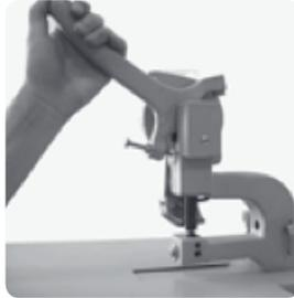
14. Stellen Sie nun mit der Stellschraube den Unterstempel so ein, dass der richtige Abstand für das zu ösende Material gegeben ist und arretieren Sie diesen in dieser Position mit der Befestigungsschraube.
